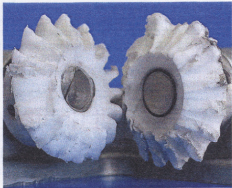
Kegelrad nach der Vergleichsbelastung aus Polyketon (l.) und POM (r.) Foto: Akro-Plastic
